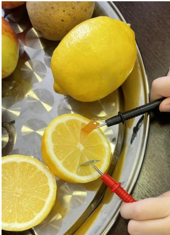
Рис. 11. Измерение напряжения лимона
