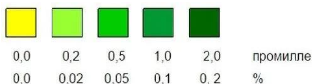
Рисунок 4 – Цветовая шкала индикаторных полосок для определения алкоголя в слюне
