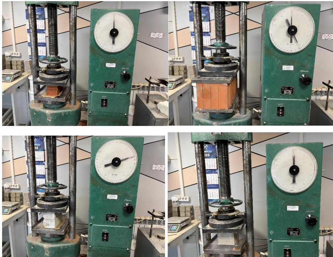
Затем образец устанавливался под гидравлический пресс, после чего нагрузка постепенно увеличивалась до полного разрушения материала. В момент разрушения фиксировалось значение разрушающей силы. На основе полученных данных предел прочности при сжатии материала рассчитывался по формуле:
