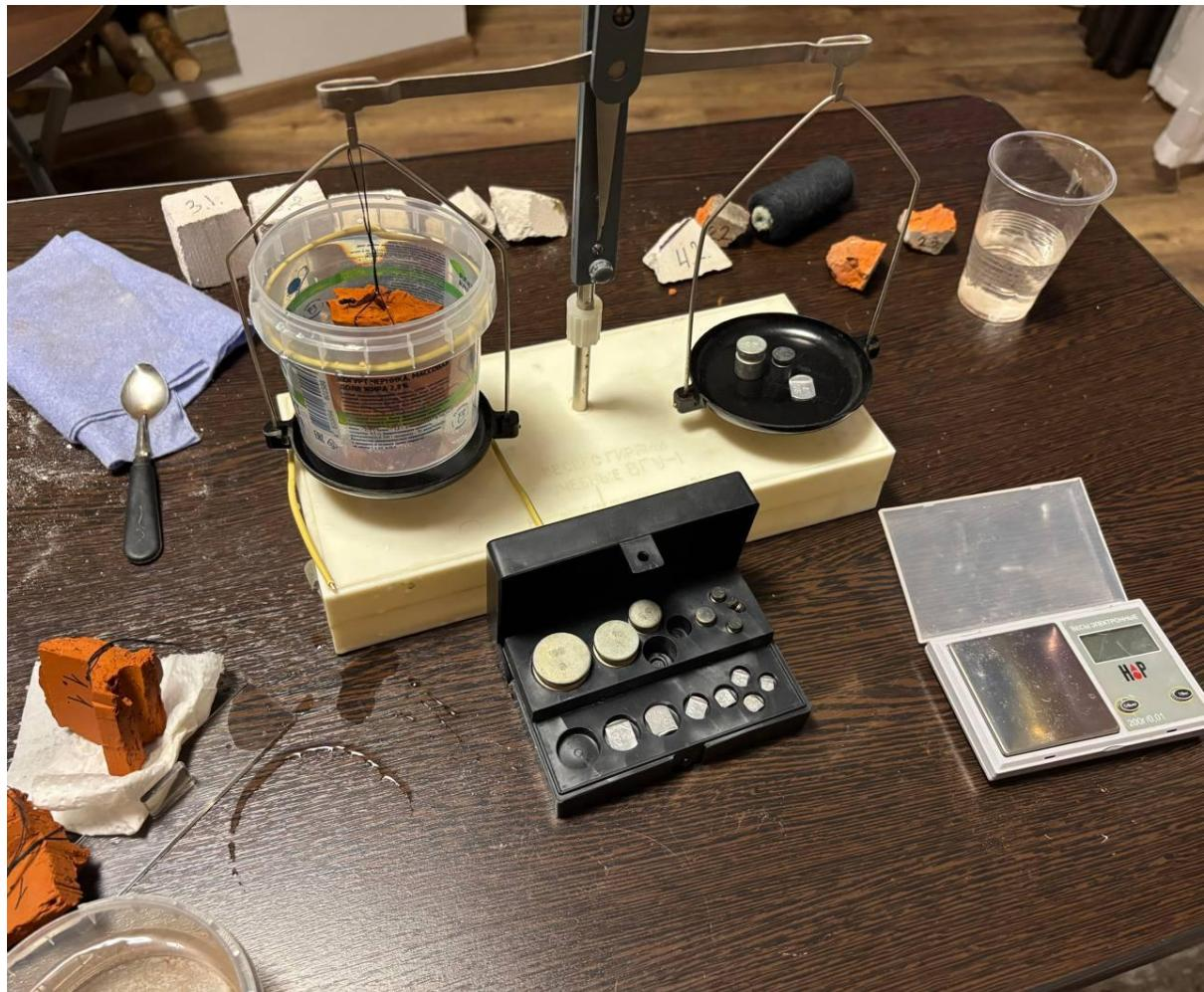
Теперь у нас достаточно информации, чтобы высчитать естественный объем образца по формуле:  $V_{\text{ест}} = \frac{(m_{\text{нас}} - m_{\text{вод}})}{\rho_{H_2O}}$ , где  $\rho_{H_2O} = 1 \frac{\text{г}}{\text{см}^3}$ .
