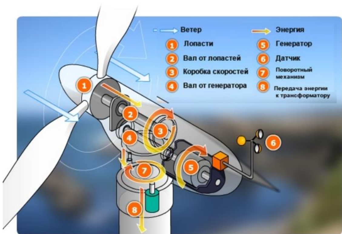
Рисунок 4 – Схема работы ветрогенератора
