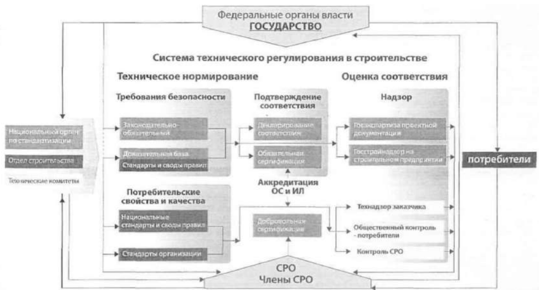
Рисунок 13. Влияние технического регулирования на улучшение качества строительства
