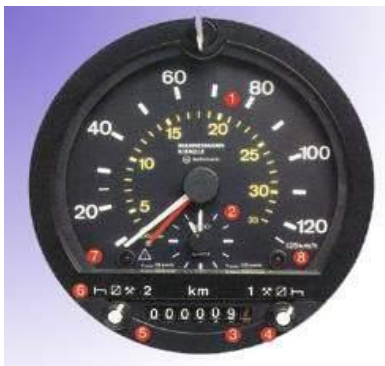
Рис. 3.1. ЕС-тахограф автомобильный: 1 – скорость; 2 – время; 3 – пройденный путь; 4 – переключатель режимов работы 1-го водителя; 5 – переключатель режимов работы 2-го водителя; 6 – режимы работы; 7 – индикатор установки диаграммного диска; 8 – индикатор превышения скорости
