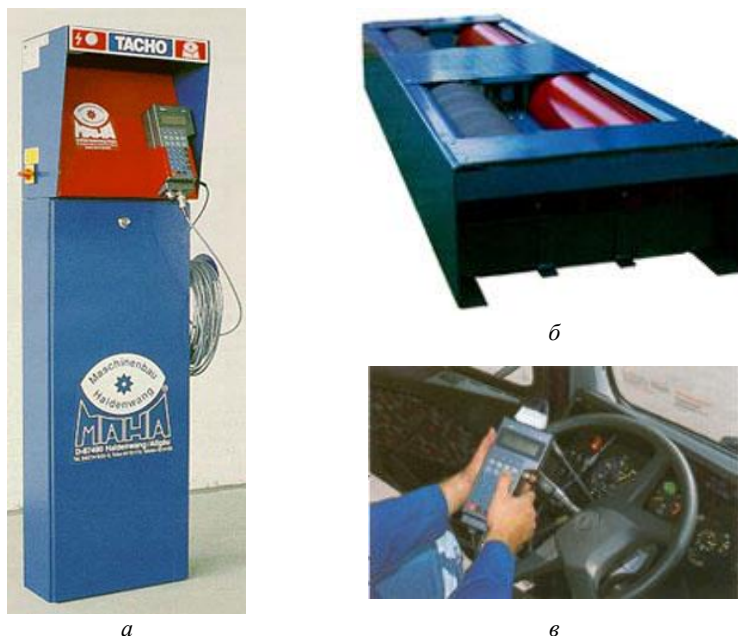
Рис. 3.7. Диагностические стенды в составе устройства диагностики тахографов: а – стенд проверки точности показаний автомобильных спидометров; б – стенд проверки точности показаний автомобильных спидометров; в – подключение прибора ТМК 1
