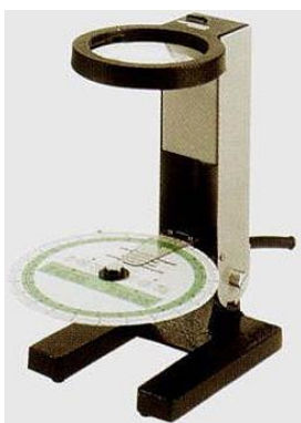
Рис. 3.6. Расшифровка диаграммных дисков с использованием увеличительных устройств
