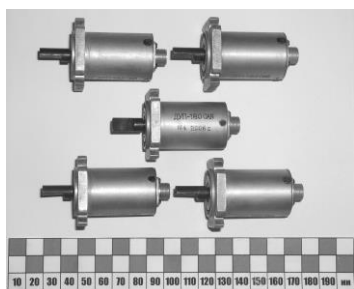
Рис. 4.3. Датчики угла поворота с цифровым выходным сигналом
