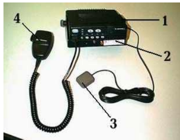
Рис. 3.17. Оборудование ТС НБ-1200
