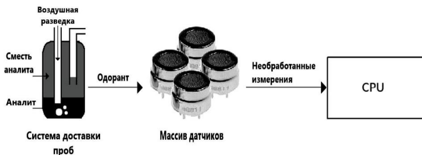
Рис. 8.1. Схема электронного носа в мобильном роботе [127, 128]
