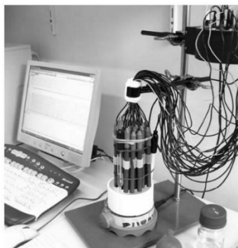
Рис. 2.10. Лабораторный прототип МС ЭЯ на основе ИСЭ [49]
