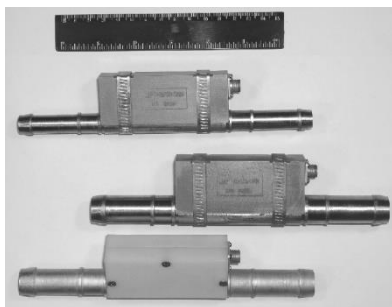
Рис. 4.5. Семейство датчиков расхода топлива с цифровым выходным сигналом для функционирования в составе СНМ АТ
