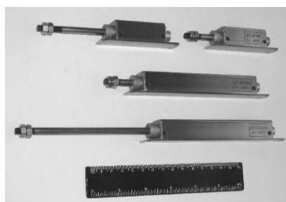
Рис. 4.4. Семейство датчиков линейных перемещений с цифровым выходным сигналом
