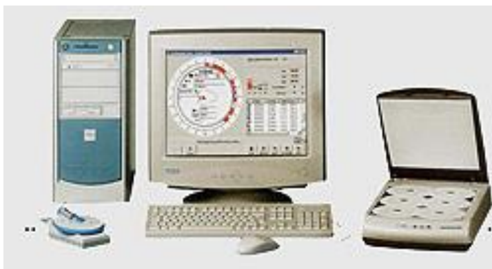
Рис. 3.5. Расшифровка диаграммных дисков с использованием ПЭВМ и сканеров
