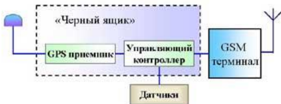
Рис. 3.14. Структурная схема бортового накопителя БН-2
