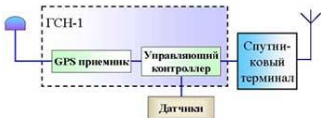
Рис. 3.16. Структурная схема бортового накопителя типа «черный ящик» ГСН-1
