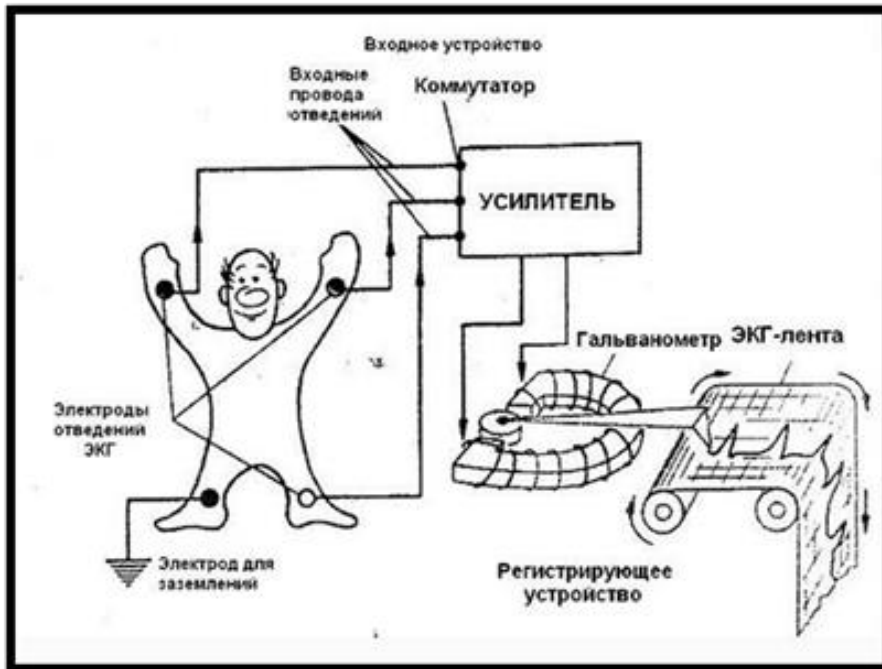
Рис.39. Устройство ЭКГ аппарата
