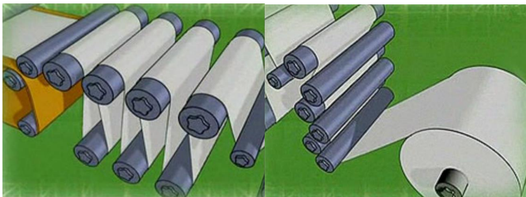
Рис. 9. Отжимают, высушивают, полируют Рис. 10. Наматывают в рулон
