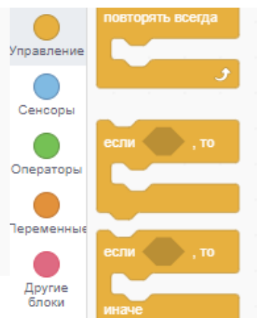
Рис. 9. Блок "Управление" с примерами команд
