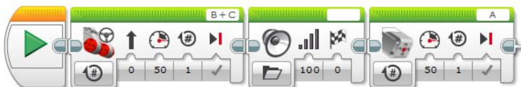
Рисунок 4. Пример записи алгоритма на языке программирования EV3
