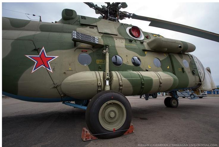
Рис.14 Основной подвесной топливный бак
