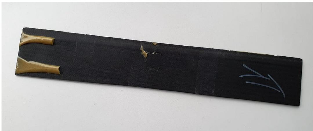
Рис. 5 Пример образца монолитной панели из препрега на основе углеродной ткани АСМ 102-С200Т
