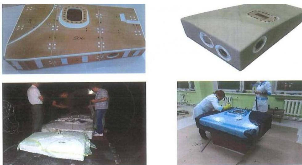
Рис.16 Аварийстойкий топливный бак
