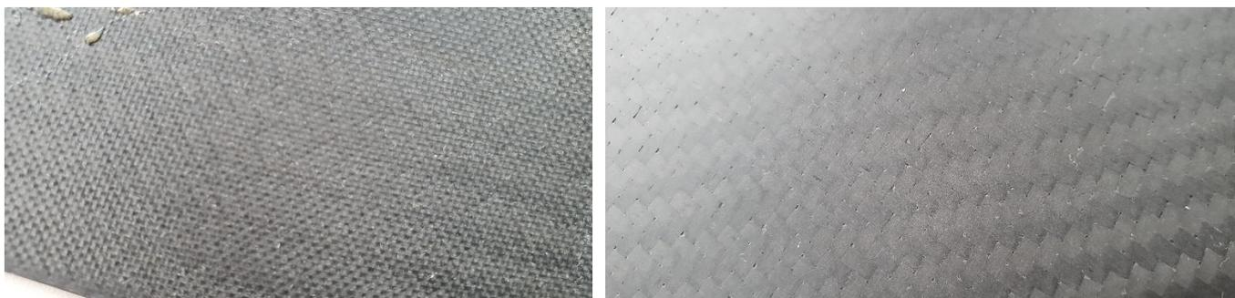
Рис.6 Структура двух сторон образца монолитной панели из препрега
