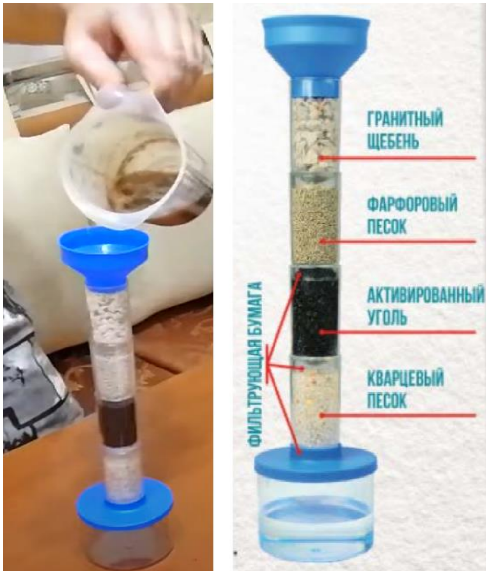
Рис. 12. Модель природного фильтра для очистки воды.
