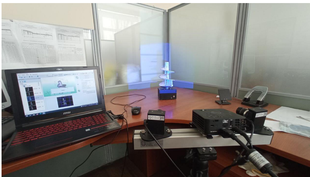
Рисунок 12. Сканирование детали – “Винт” термической печи отжига
