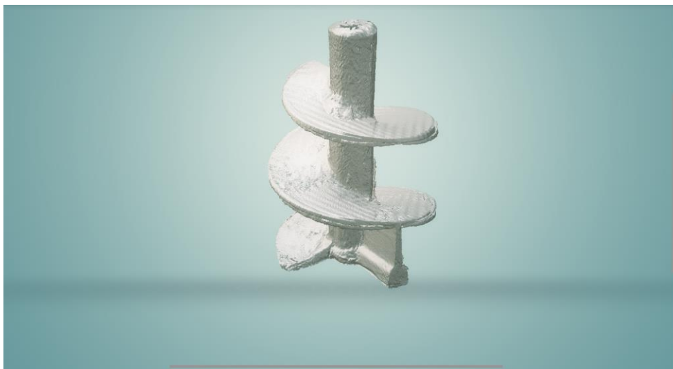
Рисунок 14. STL модель полученная путем отцифрования детали
