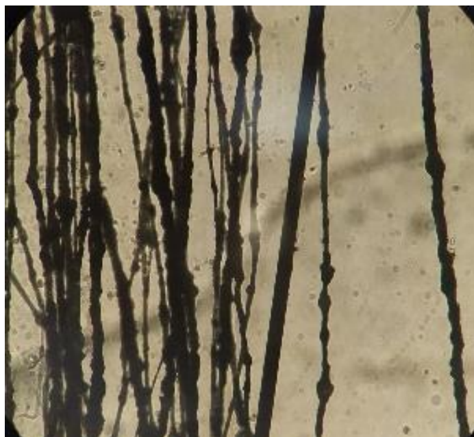
Рис. 18 Волокна ПММА, модифицированные микрочастицами магнетита
