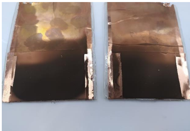
Рис. 22. Электроды электрофильтра с осажденными магнитными частицами (черный цвет)
