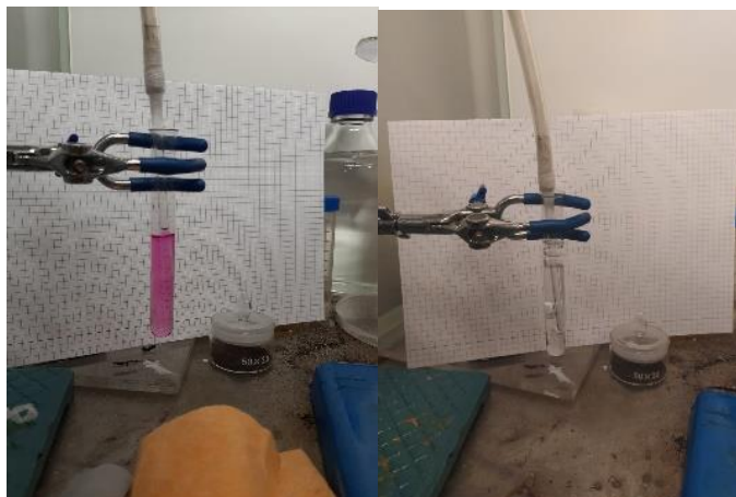
Рис. 16 Изменение окраски фенолфталеина до и после реакции с продуктами реакции доокисления CO до CO 2
