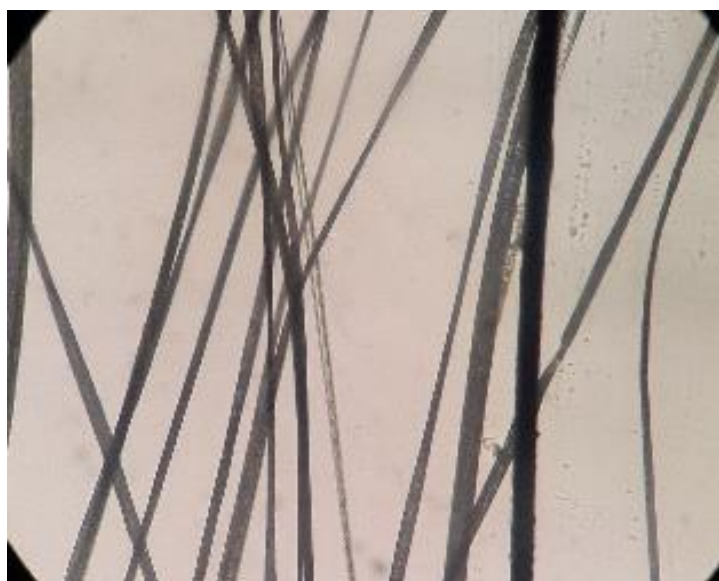
Рис. 17. Волокна ПММА, полученные методом вытягивания.
