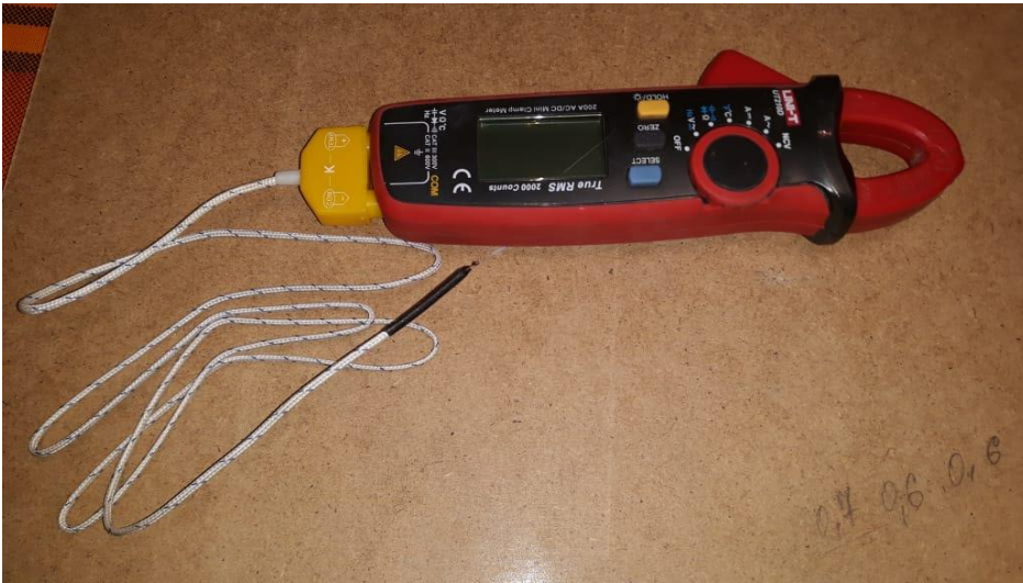
Рис.5. Мультиметр и термопара (измерение температуры в помещении и на улице)
