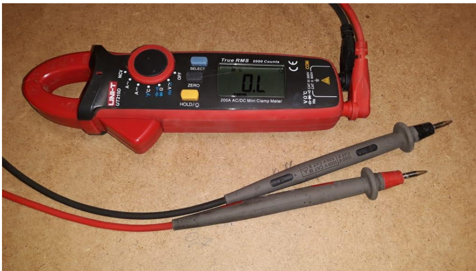
Рис.6. Мультиметр (измерение сопротивления проводника)
