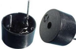
электронный компонент для воспроизведения простых звуков. Активный зуммер содержит генератор, поэтому он издает звук всегда, когда на него подано напряжение
