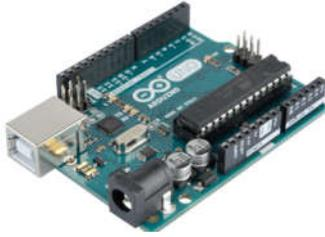
устройство на основе микроконтроллера ATmega328 (datasheet). В его состав входит все необходимое для удобной работы с микроконтроллером: 14 цифровых входов/выходов
