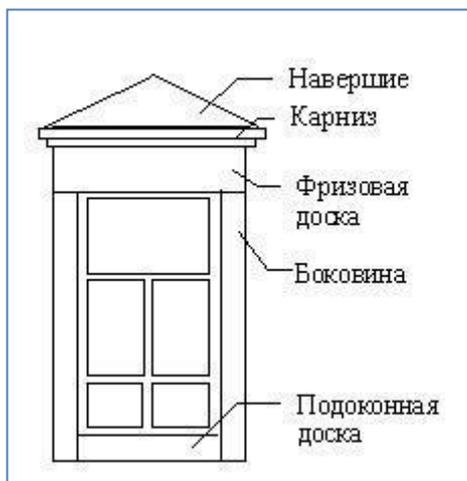
Изготавливают наличники и их детали по специальному шаблону путем выпиливания, высверливания, выдалбливания. Накладные элементы, в виде гранных кнопок или точеных розеток, закрепляют при помощи деревянных шкантов или гвоздей; реже используют клей.
