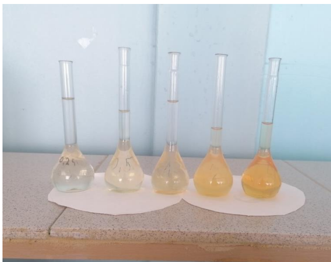
Рис 9. Шкала образцовых растворов для определения аммонийного азота на ФЭКе
