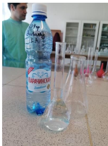
Рис. 10. Исследуемая проба на определение железа Содержание железа определяем фотоколлометрическим методом.
