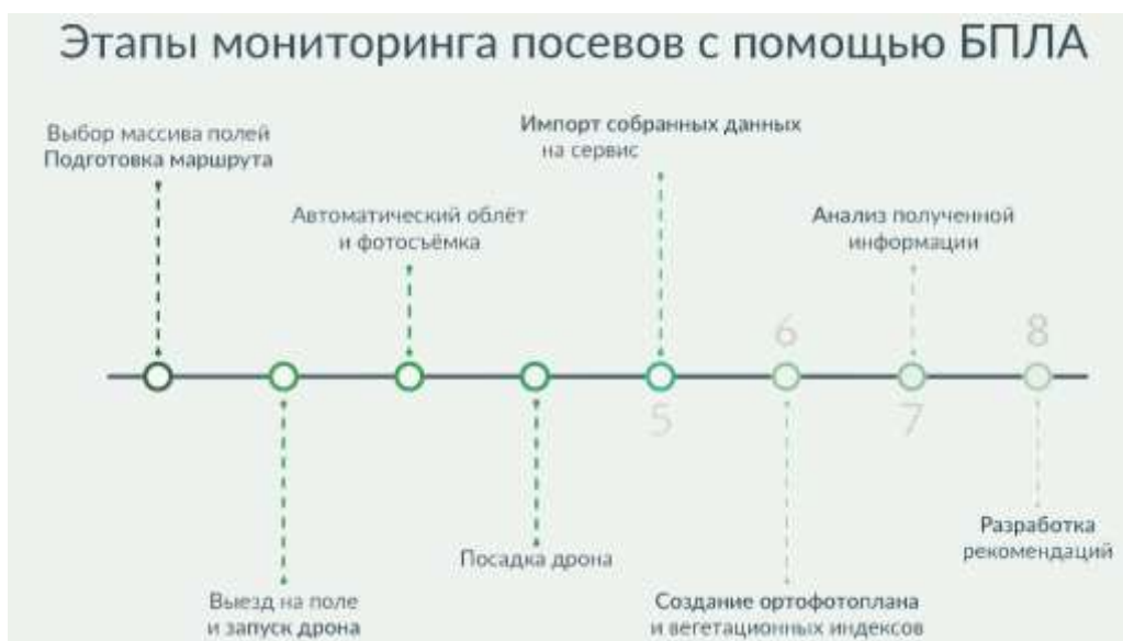
Рис.8 Технологическая схема мониторинга посевов с помощью БПЛА
