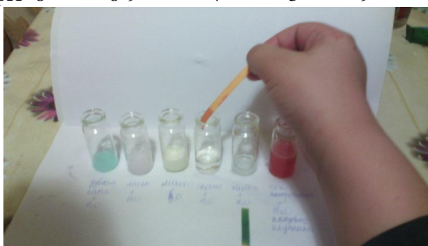
Рис. 6. Измерение pH растворов уксусной кислоты, пищевой соды, мыла, зубной пасты и молока с помощью универсальной индикаторной бумаги
