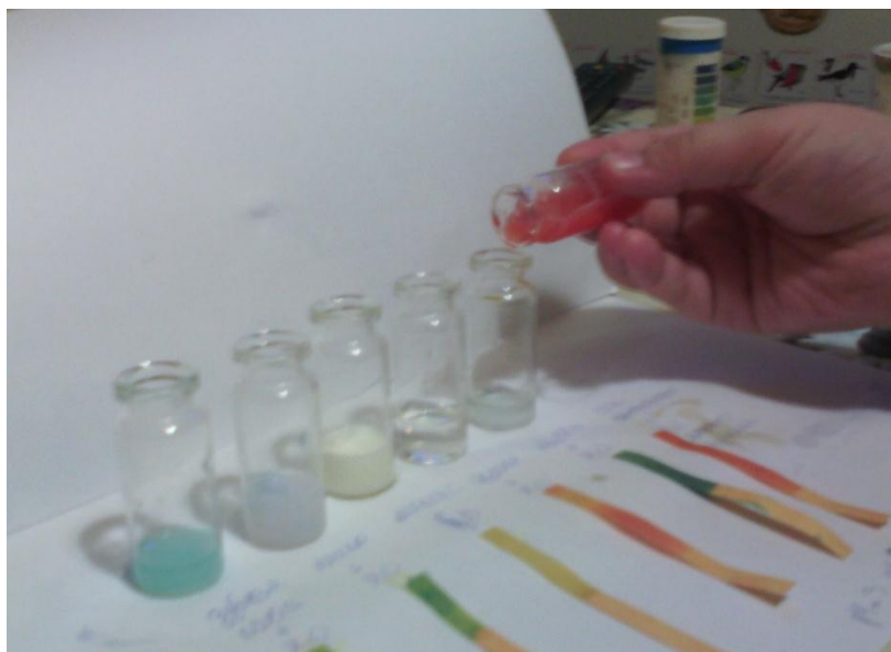
Рис. 7. . Тест-определение \text{pH} с помощью природных индикаторов
