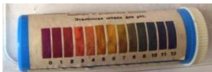
Рис. 2. Цветовая шкала для измерения pH растворов с помощью тест-полоски универсальной индикаторной бумаги
