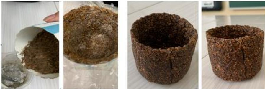
рис.5. Изготовление одноразового стакана из порошка грецкого ореха
