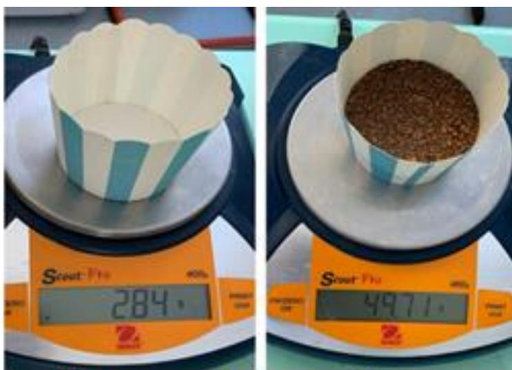
рис.4. Взвешивание полученной массы порошка
