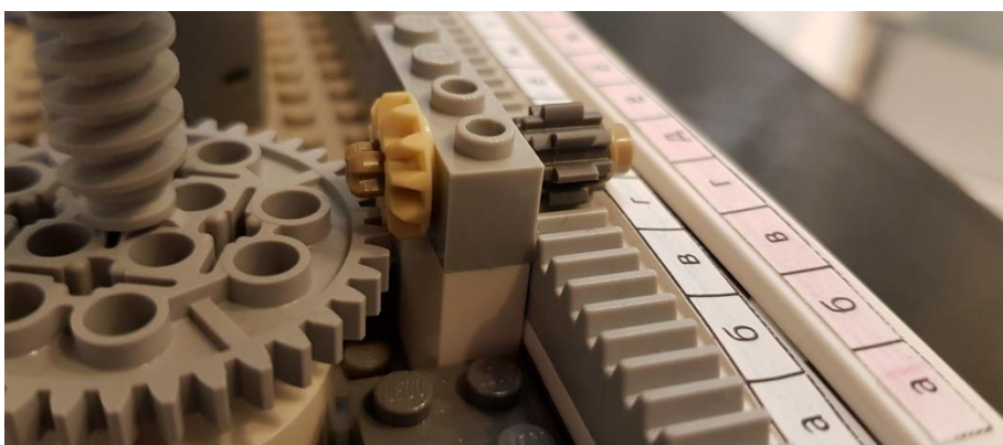
Рисунок 2. Внешний вид зубчатой и реечной передач.
