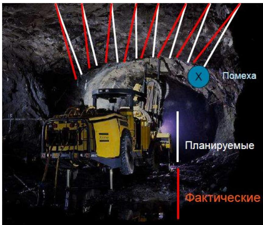
Рисунок 6 - Программный продукт, позволяющий автоматически менять буровой план на компьютере СБУ, в случае невозможности забурить какую-либо из скважин в нужном месте (помеха).
