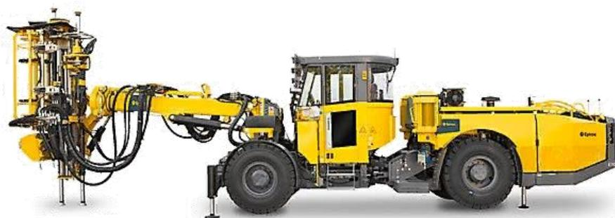
Рисунок 1 – Буровой станок Simba E7.
