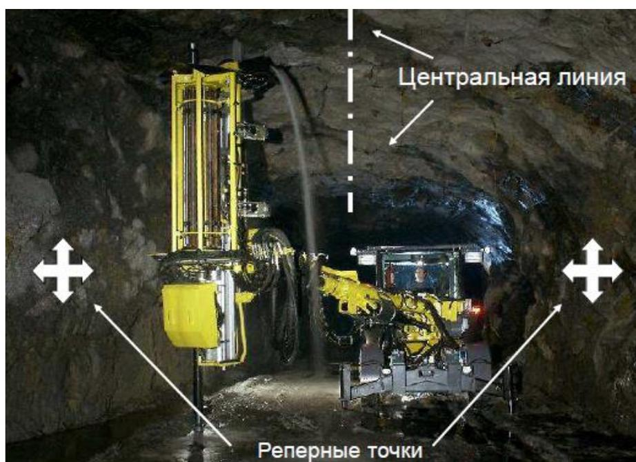
Рисунок 4 - Система навигации СБУ в тоннеле по двум точкам и центральной линии тоннеля.
