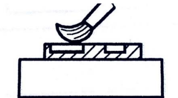
Рисунок 1.4 - Схема нанесения эмали
