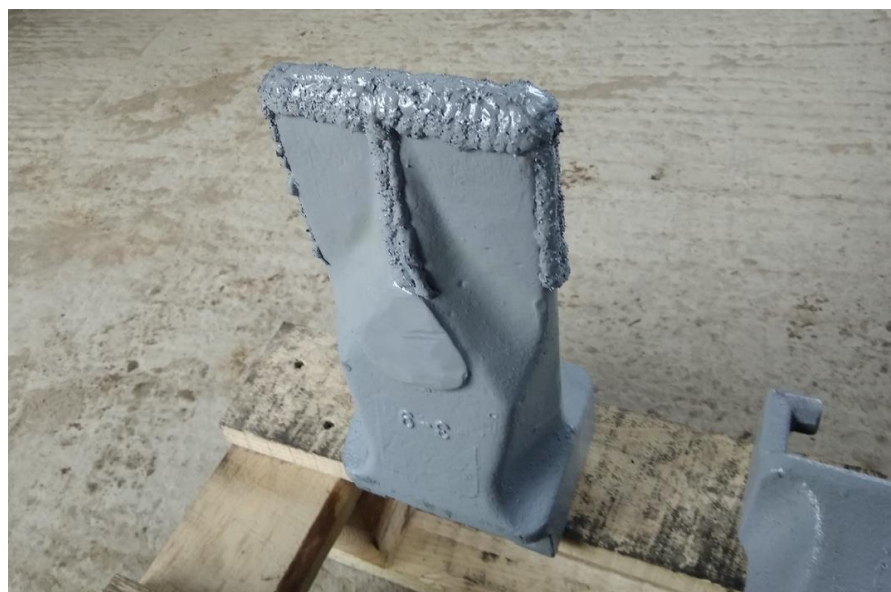
Рисунок 10. – Коронка экскаватора с наплавкой
