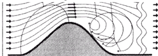
Рисунок 3 - образование турбулентности при обтекании неровностей 5-я серия экспериментов
