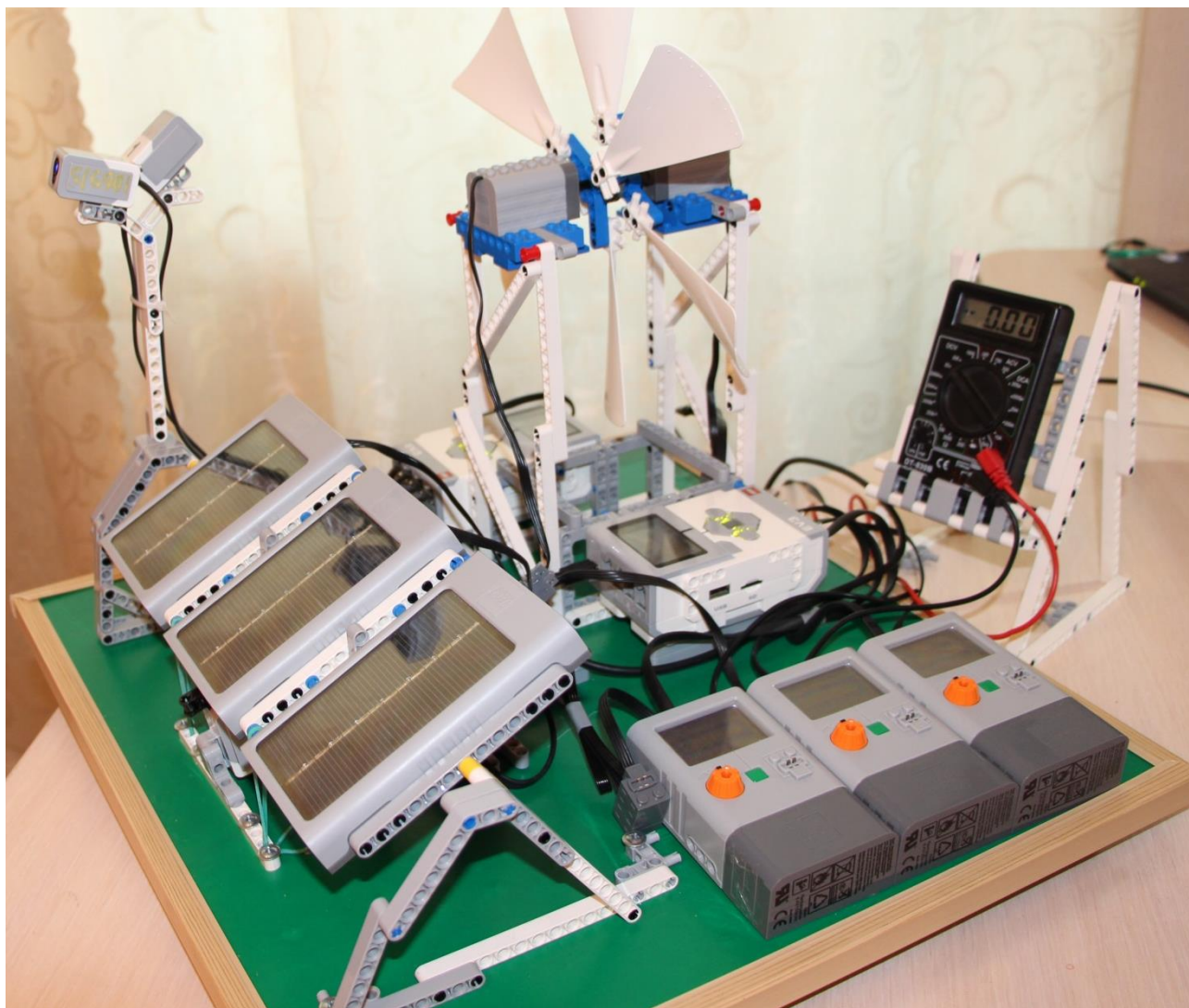
Рис. 11. Комбинированная энергетическая установка
