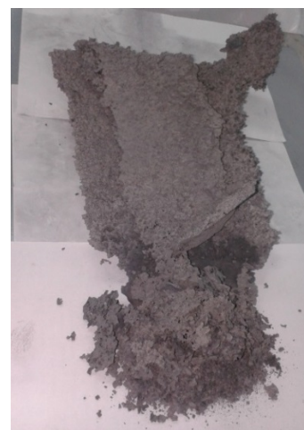
Рис. 9. Полностью деструктурированный сплав после проведения второго этапа переработки
