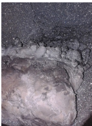
Рис. 8. Частично деструктурированный сплав после проведения первого этапа переработки
