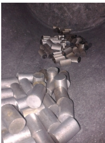
Рис. 7. Изделия из сплавов BK10 и BK20, загруженные в холодную зону реактора
