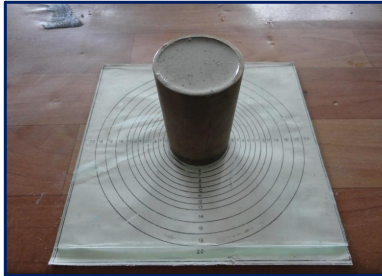
Рисунок 7. Определение стандартной консистенции гипсового вяжущего
