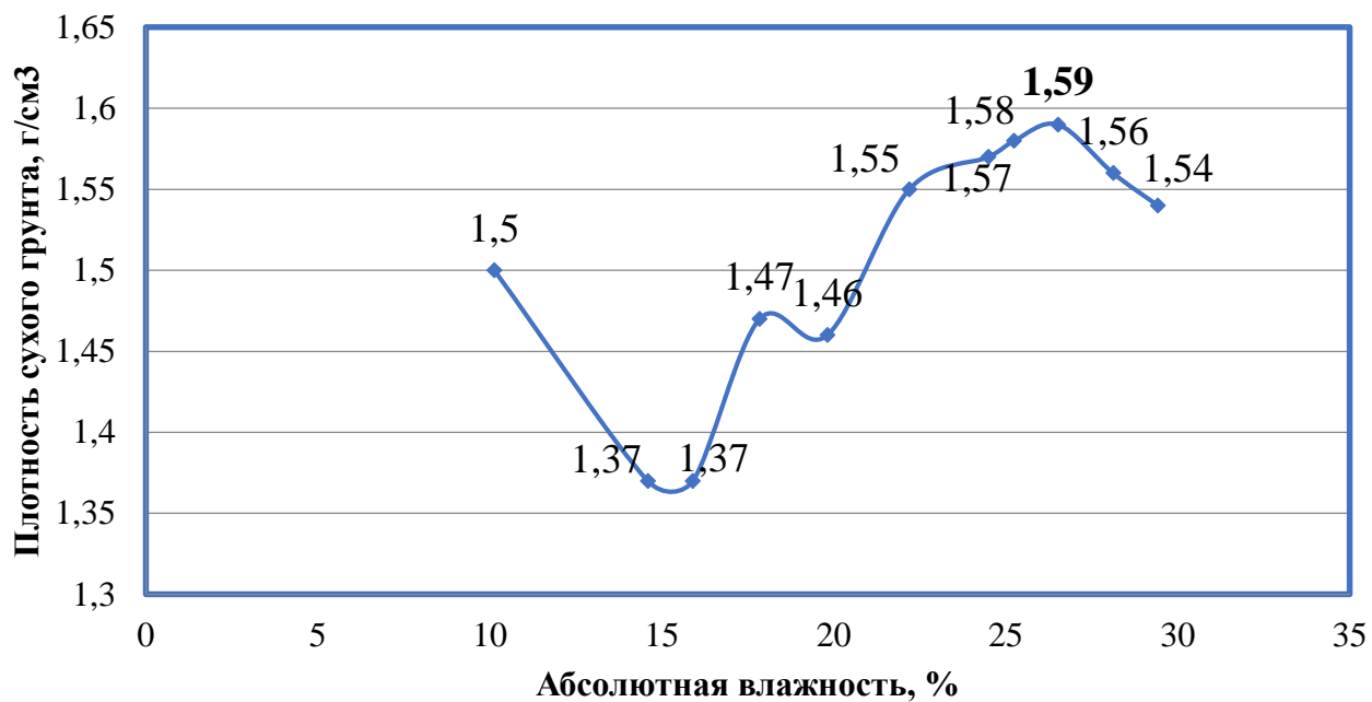
Рисунок 25. Графическое определение оптимальной влажности при максимальной плотности
