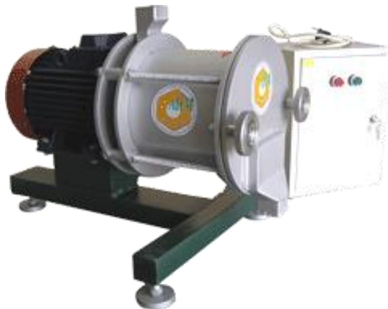
Рисунок 4. Шаровая мельница ШЛМ – 25
