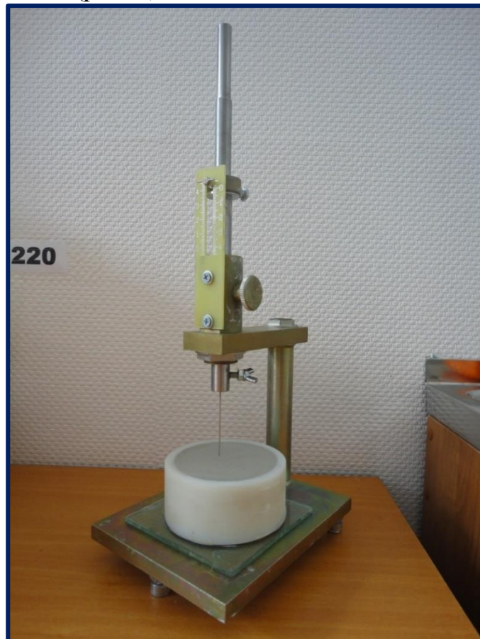
Рисунок 8. Определение сроков схватывания гипсового вяжущего
