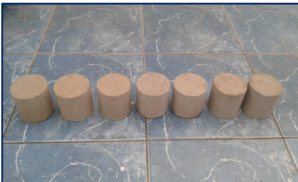
Рисунок 26. Образцы грунта, укрепленного разработанным вяжущим на разных процентных соотношениях
