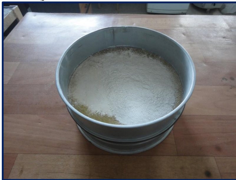
Рисунок 6. Определение тонкости помола гипсового вяжущего
