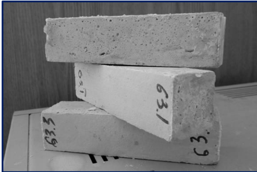
Рисунок 9. Определение прочности на сжатие гипсового вяжущего
