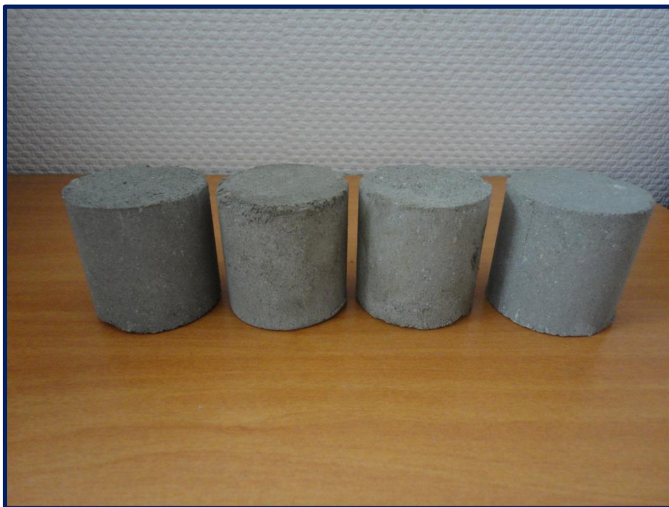
Рисунок 27. Образцы грунта, укрепленного разработанным вяжущим на разных процентных соотношениях
