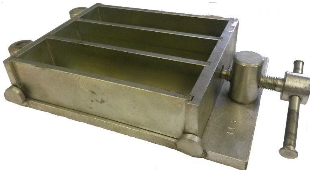
Рисунок 13. Формы для изготовления образцов-балочек
