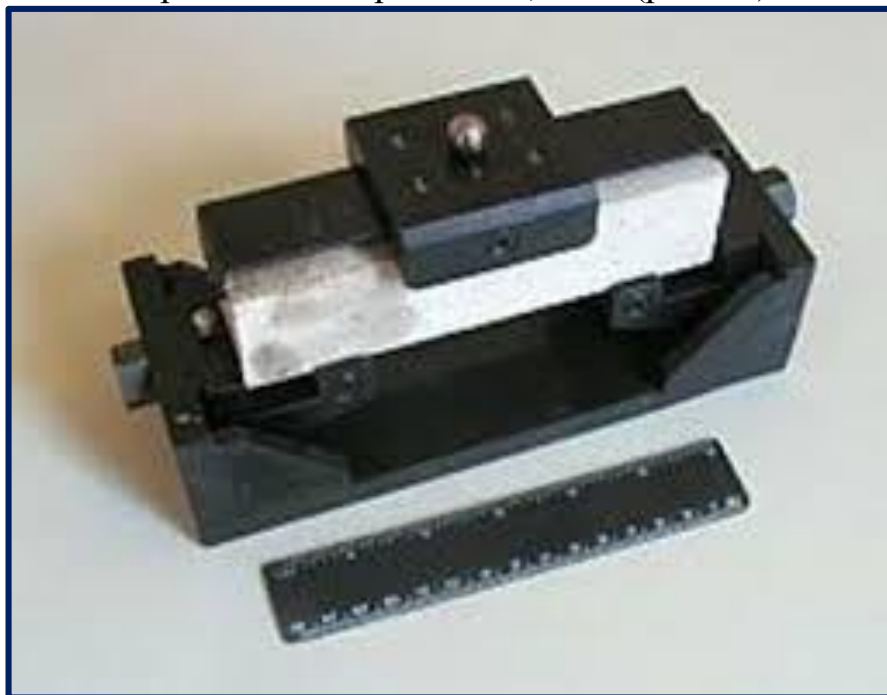
Рисунок 10. Определение прочности на растяжение при изгибе гипсового вяжущего
