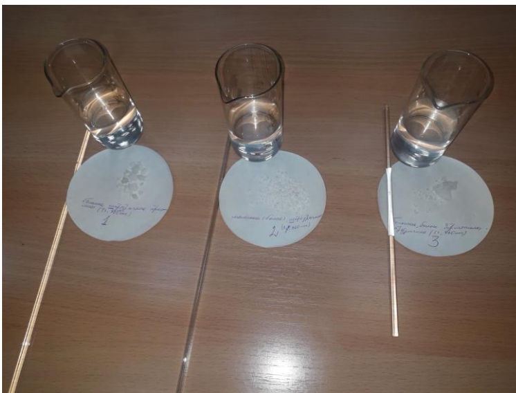
исследование содержания кислотности в разных компонентах антиобледенительного средства
