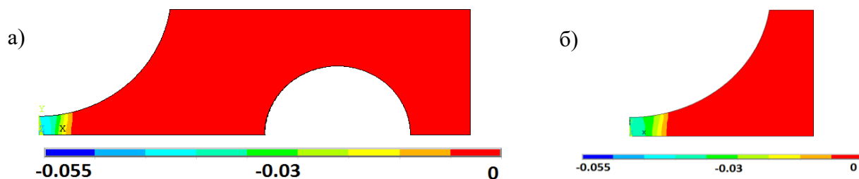
Рис. 9. Осевые пластические деформации в образце при 900°С для моделей: а) с оснасткой, б) без оснастки.
