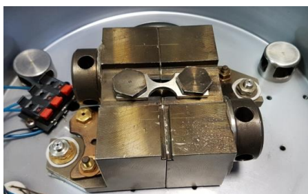
Рис. 1. Установка для проведения термоусталостных испытаний.
