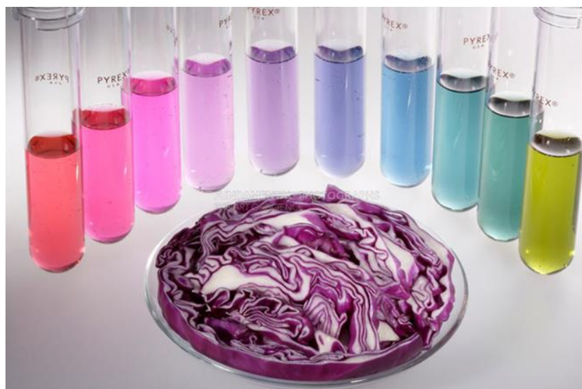
Рис. 15. Изменение окраски раствора антоцианов, выделенных из краснокочанной капусты, при изменении pH раствора от 1 до 10 (слева направо).
