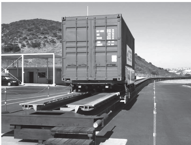
Рис. 2. Магнитолевитационная линия для транспортировки контейнеров
